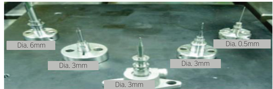
[ SMA 공구 클램핑 시스템 프로토타입 ]
